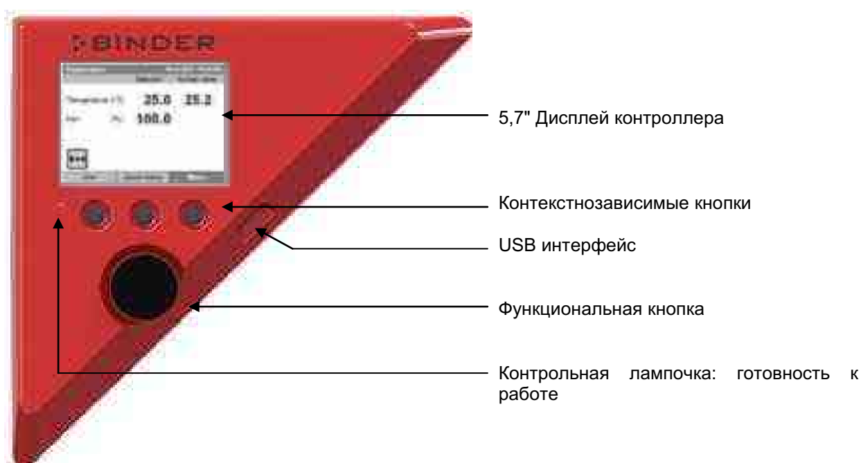
Рисунок 4: Панель контролера с микропроцессорным контроллером T4.12 и USB интерфейсом
